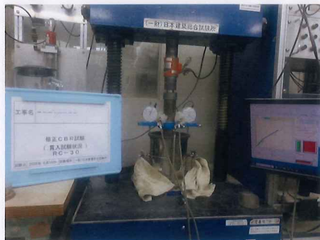
1.8 修正CBR試験（貫入試験状況）
