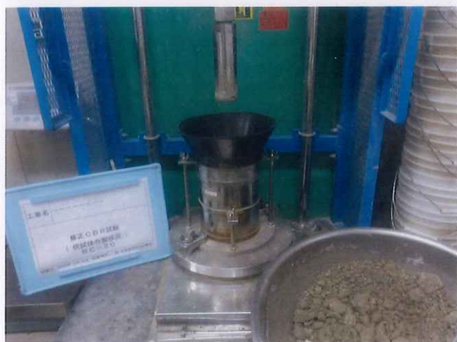
1.7 修正CBR試験（供試体作製状況）
