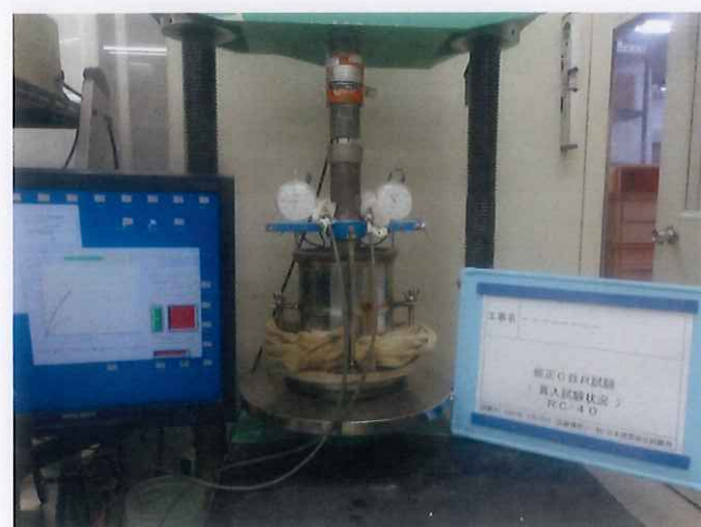
1.8 修正CBR試験（貫入試験状況）
