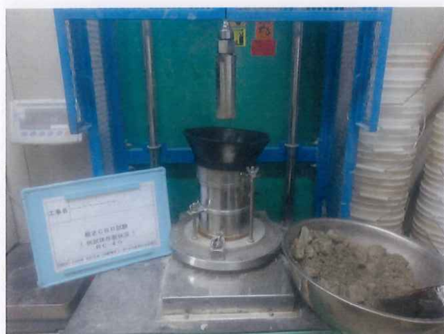
1.7 修正CBR試験（供試体作製状況）
