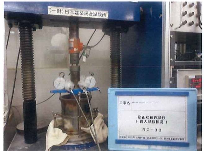
1.8 修正CBR試験 (貫入試験状況)
