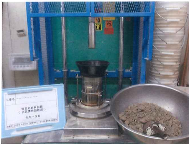
1.7 修正CBR試験 (供試体作製状況)
