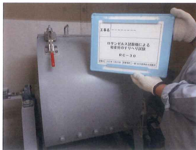
1.4 ロサンゼルス試験機による粗骨材のすりへり試験
