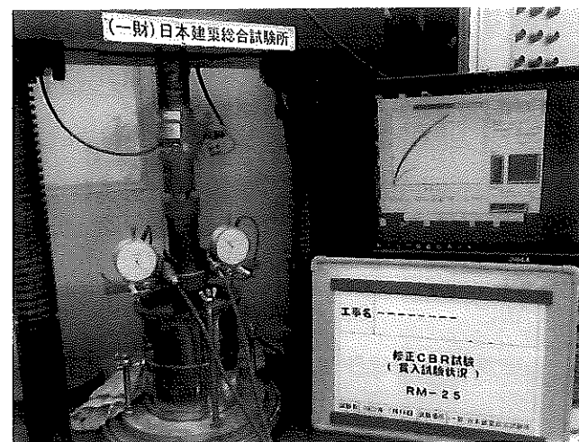
1.8 修正CBR試験 (貫入試験状況)
