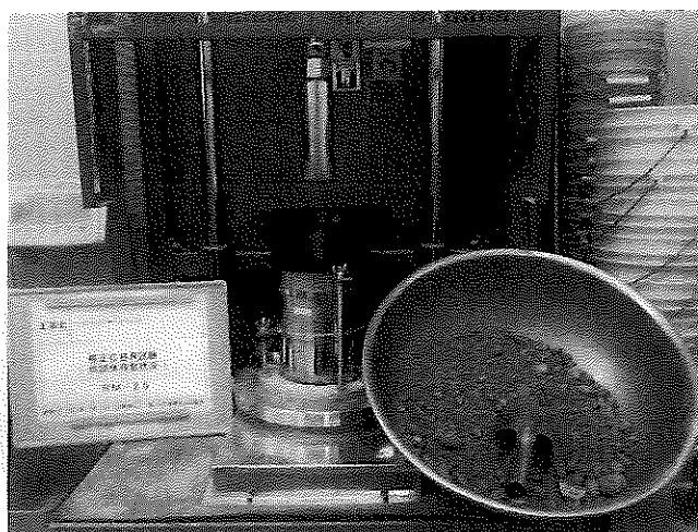
1.7 修正CBR試験 (供試体作製状況)
