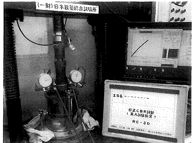
1.8 修正CBR試験 (貫入試験状況)
